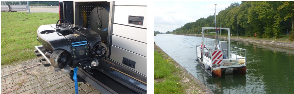
*Abbildung 16: Das eingesetzte Unterwasserfahrzeug (links) und das Messboot mit Fächerecholot (rechts)*
