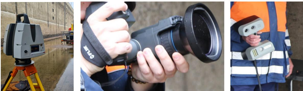
Abbildung 15: Eingesetzter terrestrischer Laserscanner (links), Wärmebildkamera (Mitte) und handgeführter Triangulationsscanner (rechts)
