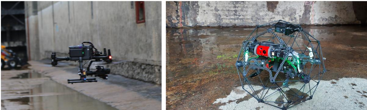
Abbildung 13: *Eingesetzte Drohne für den Außenbereich (links) und für den Innenbereich (rechts)*
