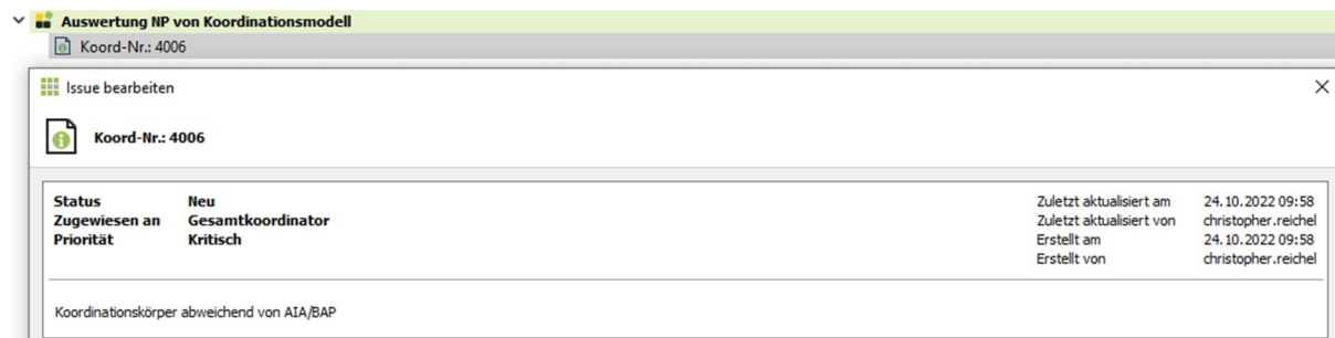
Abbildung 37: Desite: Automatische Erstellung von Issues bei Abweichungen
