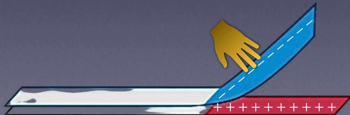
In diesem Fall wird das obere Band negativ geladen, so dass sich auf dem Teil seiner unteren Oberfläche, der das untere Band nicht mehr berührt, ein Überschuss an Elektronen oder negativen Ionen (Anionen) befinden muss. Für das untere Band gilt das Gegenteil.
